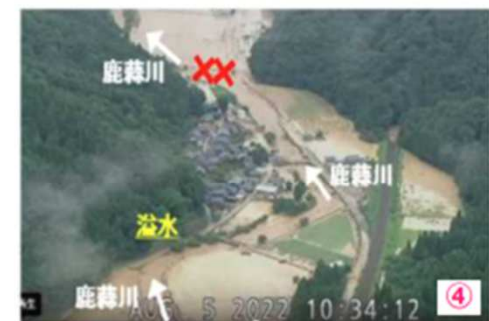
福井県南越前町 九頭竜川水系鹿藪川の堤防決壊による氾濫状況
